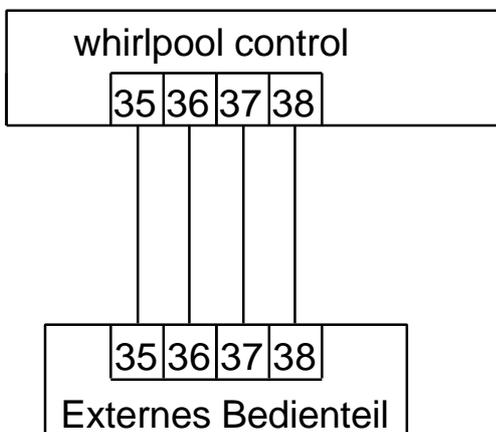
Zur Verbindung mit der Whirlpoolsteuerung dient eine 4adrige Telefonleitung (Art.Nr.3100000500) mit einer Länge von maximal 50m. Eine Verlegung der Verbindungsleitung in der Nähe von Netzleitungen ist zu vermeiden, um mögliche Störeinflüsse auszuschließen.
